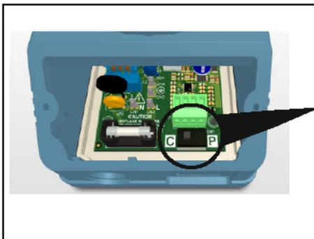
Переключатель (показанный на рисунке), который регулирует дозирующую частоту насоса, находится на детали, относящейся к электрическим подключениям схемы.
