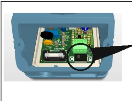
Переключатель (показанный на рисунке), который регулирует дозирующую частоту насоса, находится рядом с контактами 1-4.
