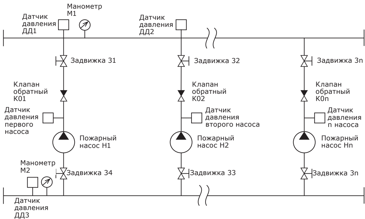
Рис. 3 Общая принципиальная схема установки Hydro-FS-V
