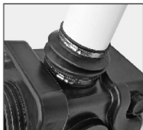
Рис. 9 Монтаж вентиляционного трубопровода
