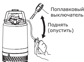
Рис. 10 Проверка направления вращения насоса с поплавковым выключателем
