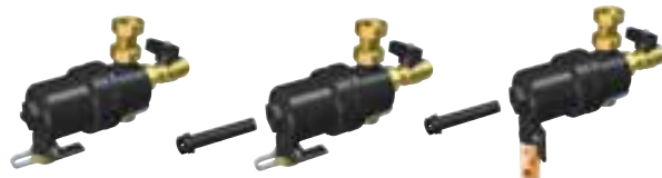
Закрытие отсечного вентиля
