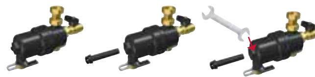
можно полностью открутить стакан с помощью стандартного гаечного ключа СН 29
